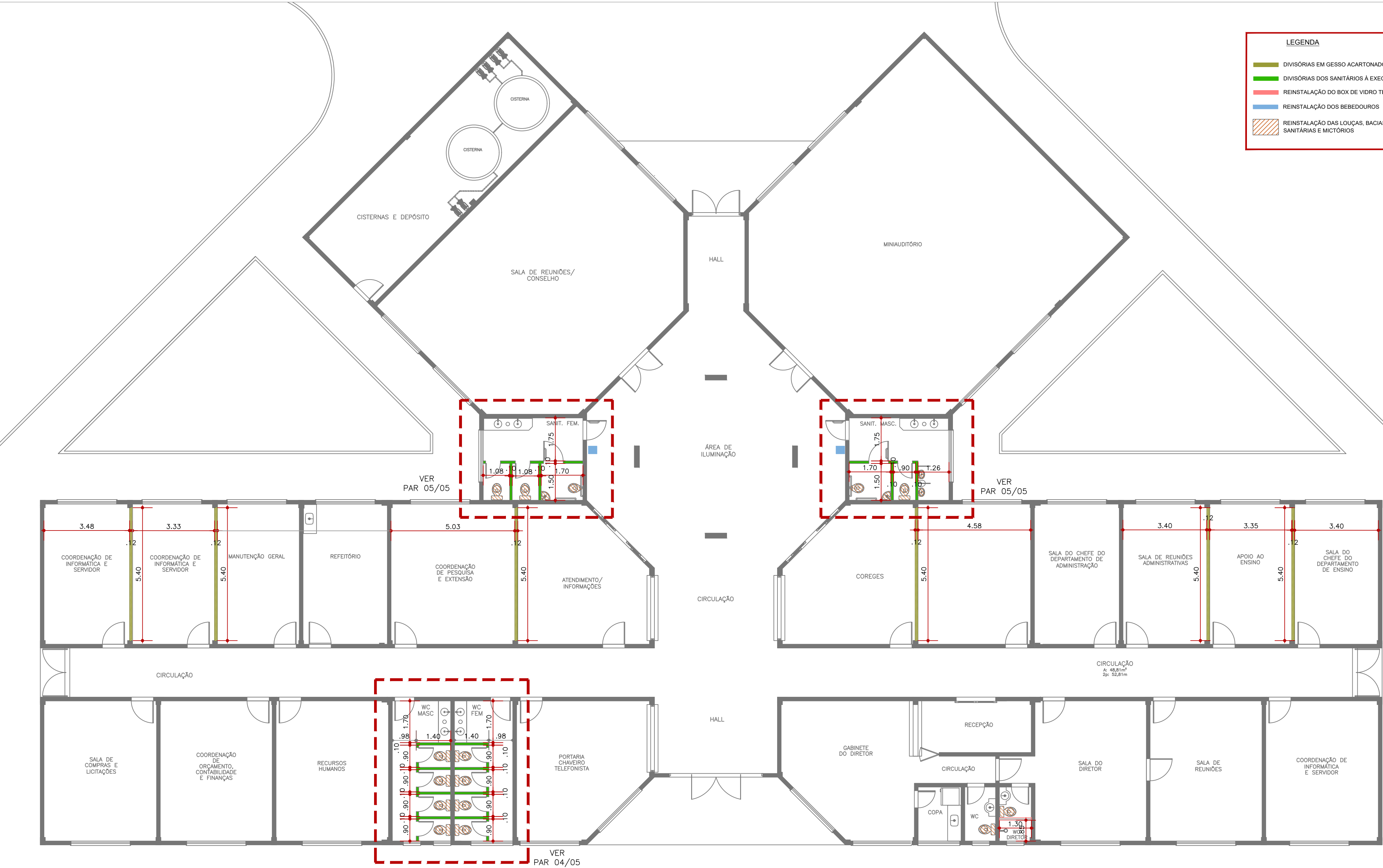
PLANTA DE INSTALAÇÃO DE DIVISÓRIAS E REINSTALAÇÃO DE LOUÇAS E EQUIPAMENTOS ESCALA: 1/100
