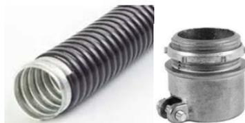
Nas paredes de gesso acartonado, utilizar eletroduto corrugado, diâmetro 3/4", de primeira linha. Referencia marca Tigre e/ou similar. Os eletrodutos serão fixados as caixas através de fixador para eletroduto corrugado.
